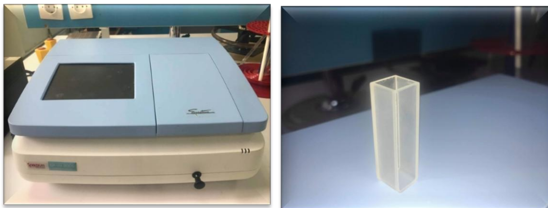
Figure 52 : Spectrophotomètre UV-Visible Cuve en quartz.
