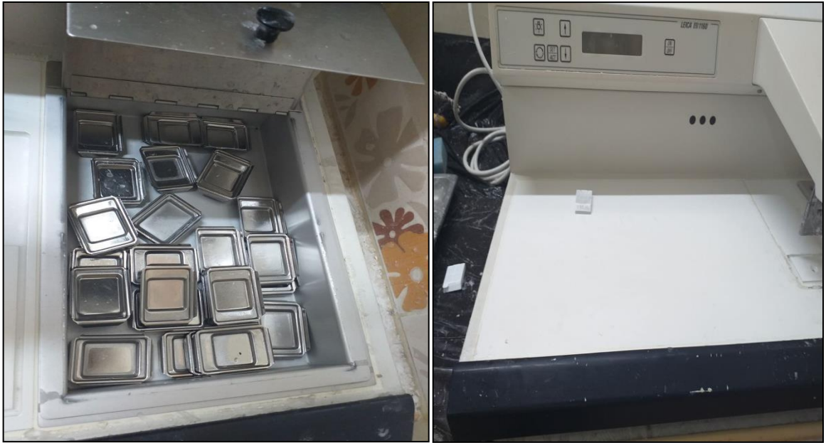
Figure 3. Les moules d'enrobage (Originale).
