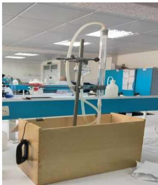
Figure 22 : Le calcimètre utilisé pour la mesure du Calcaire Total ( \text{CaCO}_3 ).
