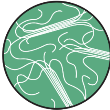
Figure 10– Structure semi cristalline d'un polymère.
