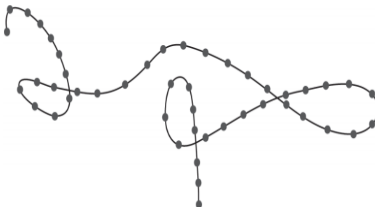
Figure 6– Schématisation de la chaîne d'un polymère linéaire.
