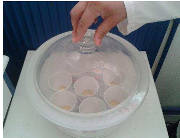
Figure 08 : La détermination de la matière sèche de lait de brebis (par Etuvage et Dessiccation)
