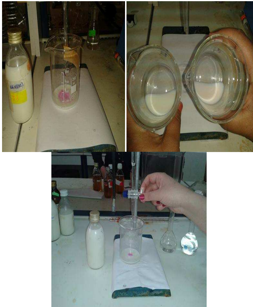
Figure 06 : Dosage de l'acidité titrable de lait cru de brebis
