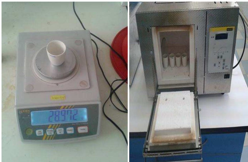
Figure 09 : Détermination de la matière minérale de lait par incéniration.
