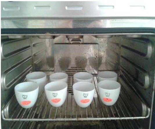
Figure 08 : La détermination de la matière sèche de lait de brebis (par Etuvage et Dessiccation)
