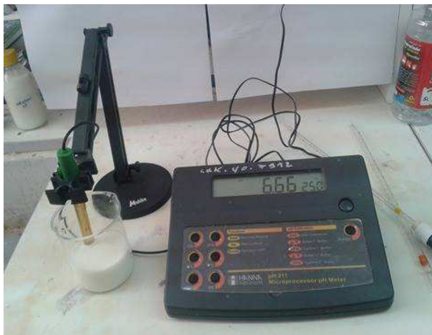
Figure 05 : Mesure de pH de lait cru de brebis a l'aide d'un pH mètre
