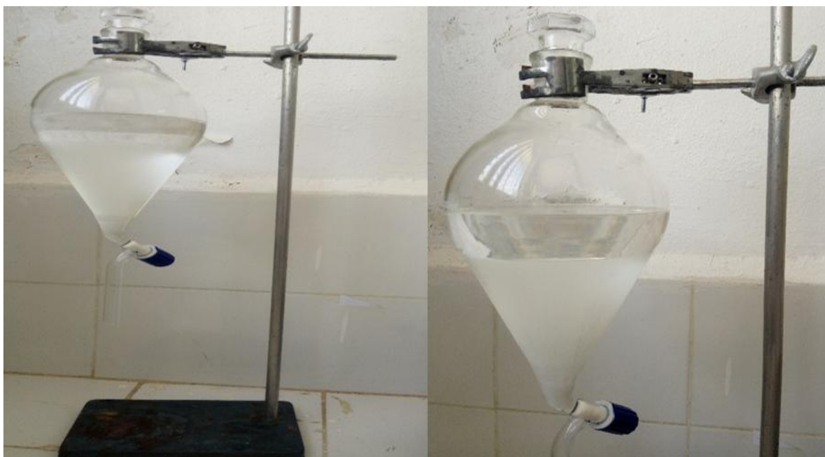
Photo 3: Montage de la décantation.
