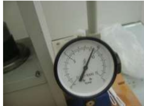
Cadran de lecture de la pression indiquant ~10 t appliquée lors du pastillage
