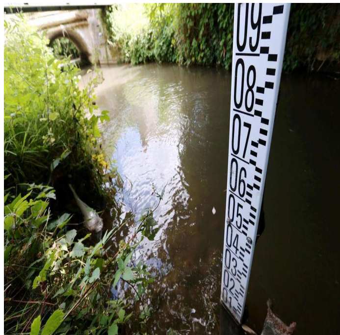
Figure.30: Echelle limnimétrique verticale
