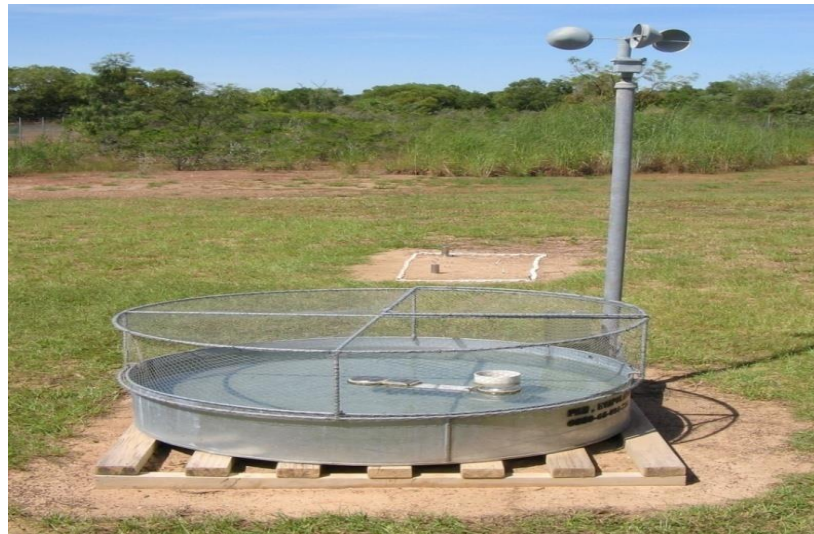
Figure.27: Bac de classe A avec station météorologique et cage de protection.
