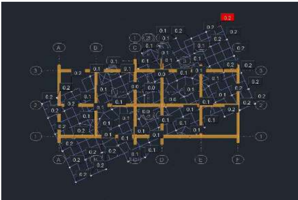
Fig(IV.6): 3 ème mode de déformation de la structure « mode 3 : torsion autour de z ».
