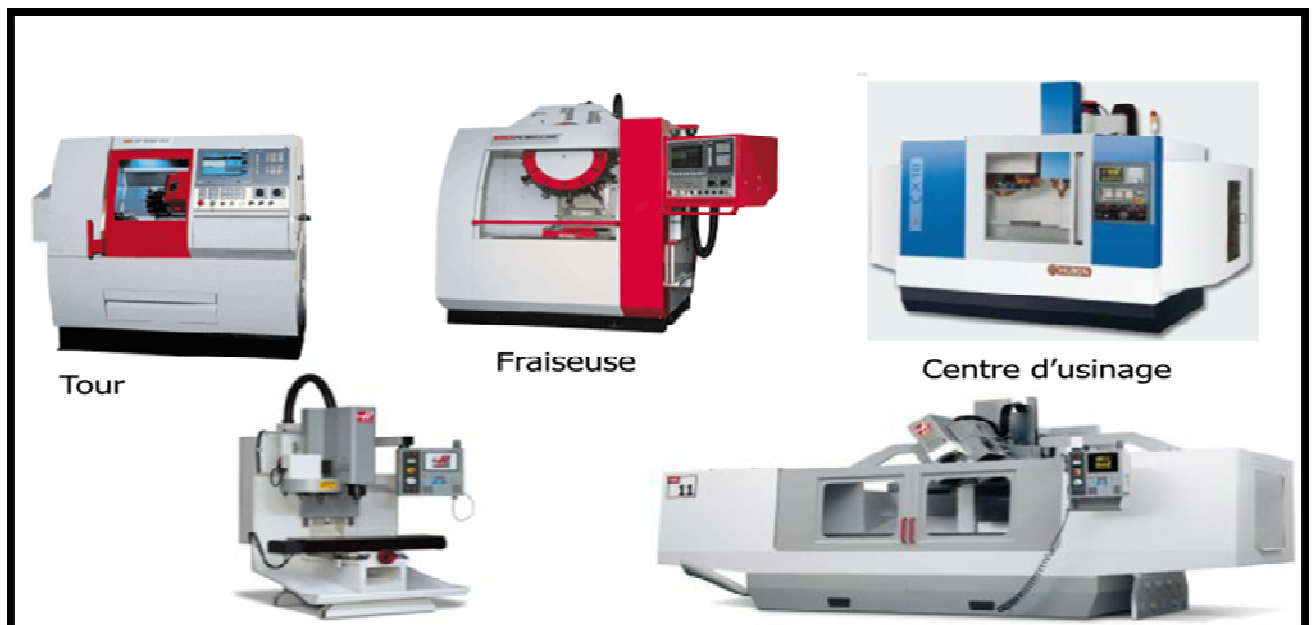
Figure I.5. Machine à commande numérique
