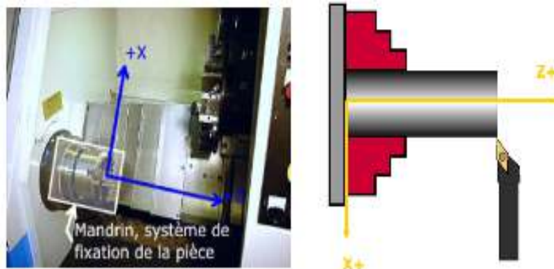
Figure I.14. Système d'axes pour un tour
