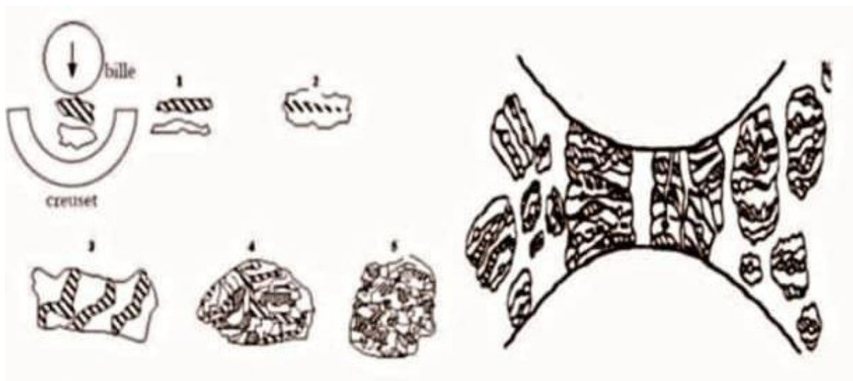
Figure I-15 : Schéma de principe du broyage à haute énergie : alternance de déformations plastiques, fractures, collages. [39]
