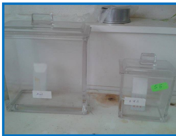
Figure IV-28 : Migration des constituants de l'extrait lors d'une CCM analytique.
