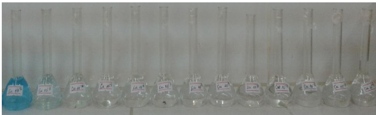
Figure 3.7. Les échantillons de chlorure de cuivre dissout dans une solution tampon de phosphate à différentes concentrations ( 10^{-2} M à 10^{-14} M).
