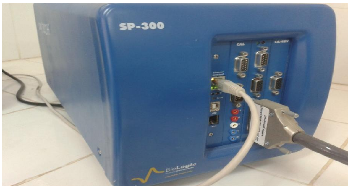
Figure 3.1. Potentiostat/galvanostat utilisé pour la volta-métries.
