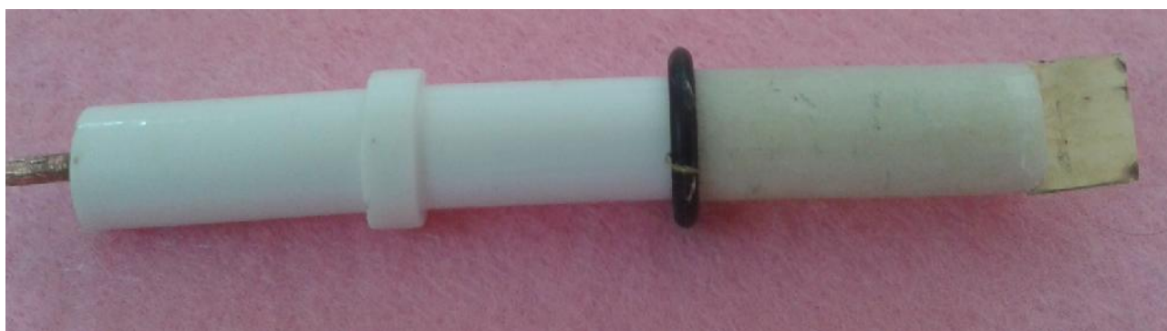
Figure 3.4. Electrode d'Or réalisée au sein de laboratoire LCIP.
