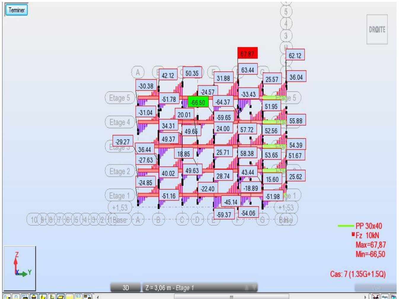
Figure V.15: diagramme de l'effort tranchant à l'E.L.U
