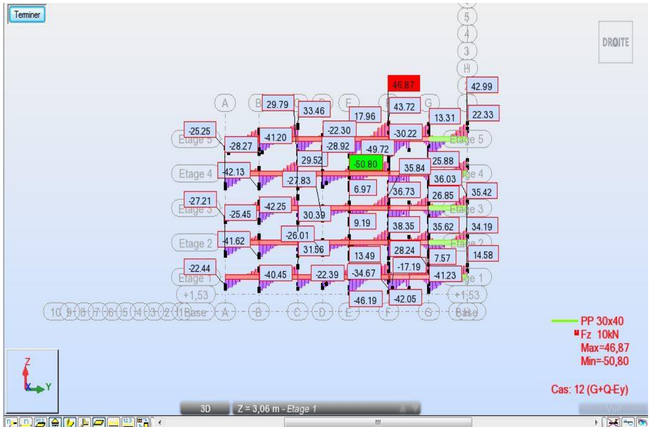
Figure V.19: diagramme de l'effort tranchant à la situation accidentelle G+Q-Ey
