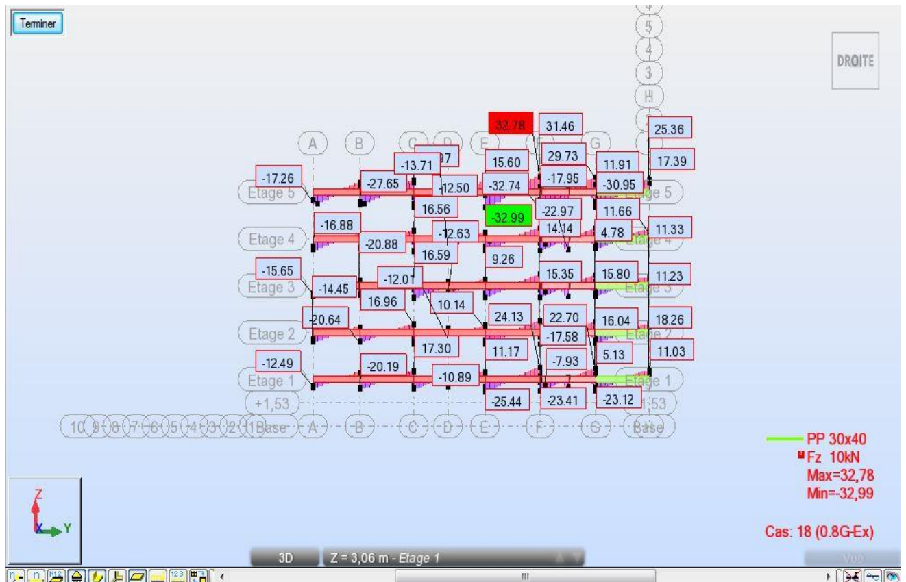
Figure V.22: diagramme de l'effort tranchant à la situation accidentelle 0,8G-Ex
