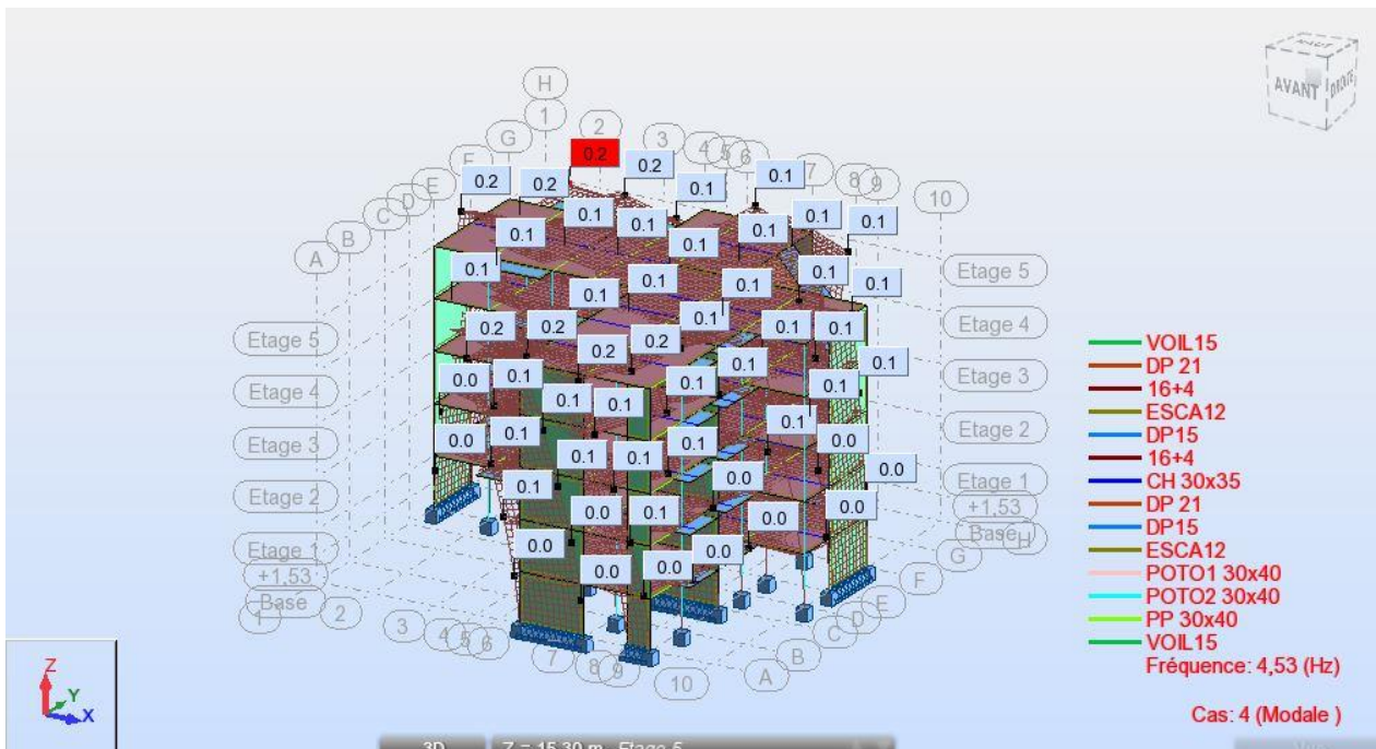
Figure IV.14 : les valeurs de déformation mode3
