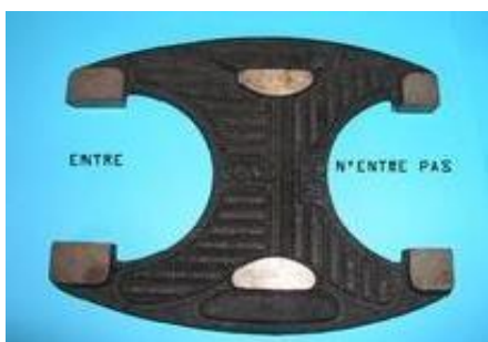
Figure II-7 : Gabarits à mâchoire double
