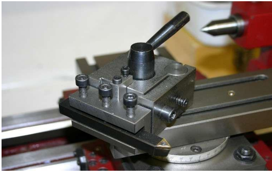
Figure IV 2 Porte à outil de fixation de notre outil de gorge
