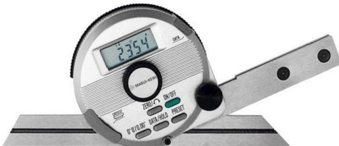
Figure II-38 : Rapporteur d'angle universel numérique
