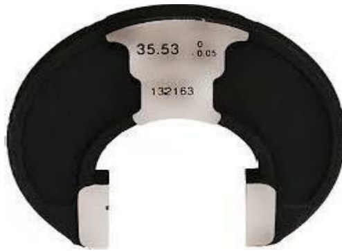
Figure II-9 : Mâchoire dite par enfilade
