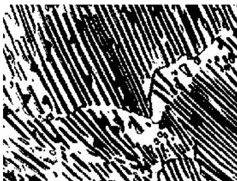
Figure III-16: Structure perlitiques dans un acier eutectoïde
