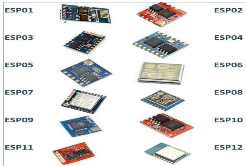
Figure 1.21 : Les modules ESP8266
