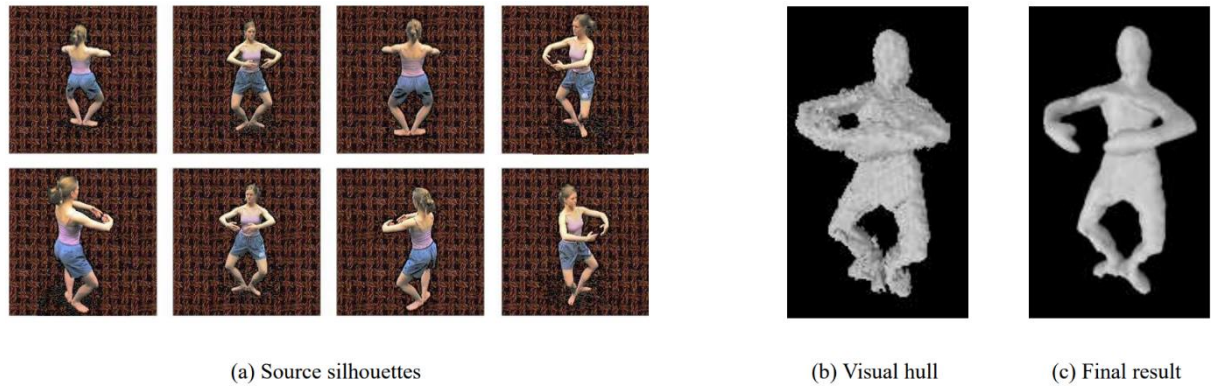
Figure II.17 Résultat proposée par Goldluecke et Magnor dans [35] (a) des images source obtenu à partir des caméras (b) Coque visuelle raffinée, représentant la surface initiale. (c) Résultat final après l'exécution de l'algorithme complet.
