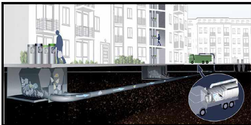
Figure II.1 : Schéma de principe de la collecte pneumatique des ordures ménagères
