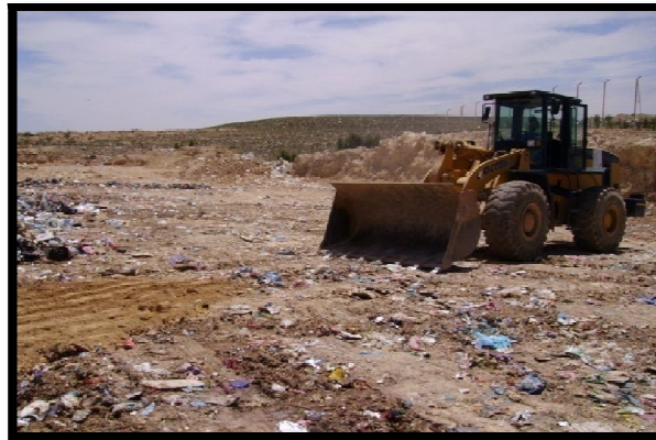
Figure III.22: Couverture journalière du casier
