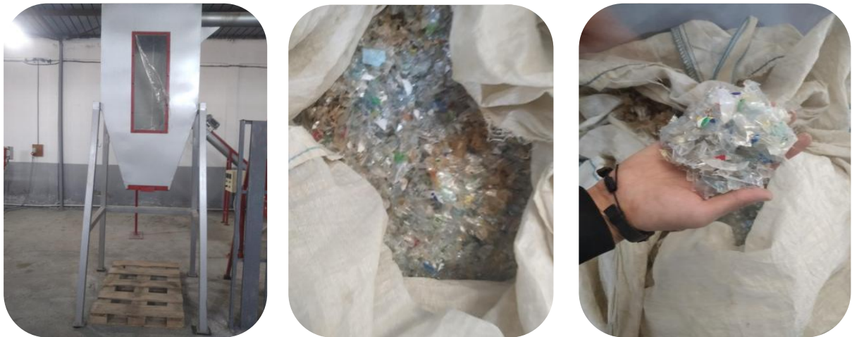
Photographie 11 : Tête de récupération des paillettes et sac rempli du produit final
