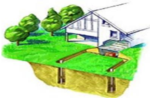
Figure II-4 : principe de chauffage géothermie verticale
