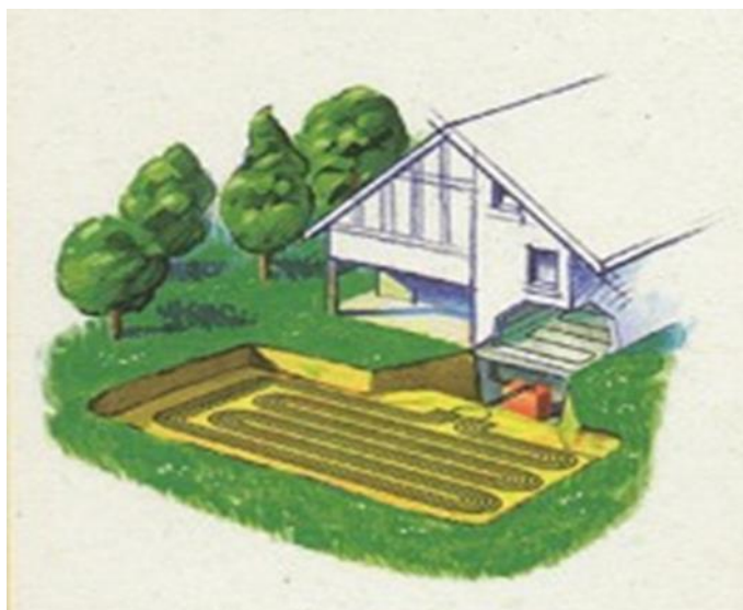
Figure II-3 : principe de chauffage géothermie horizontale
