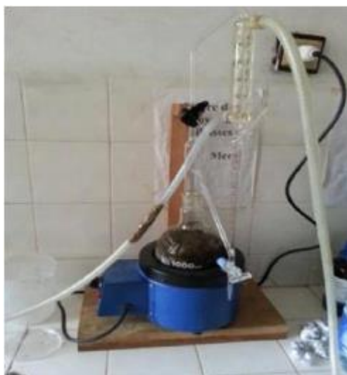
Figure.36. Dispositif d'extraction des huiles essentielles de type Clevenger.
