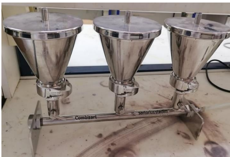
Figure 39 : La rampe de filtration utilisée (sartorius)
