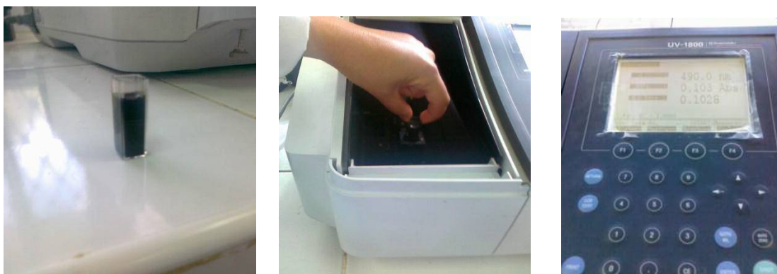
Fig. 8- Détermination de la teneur en lactose par méthode spectrophotométrique.
