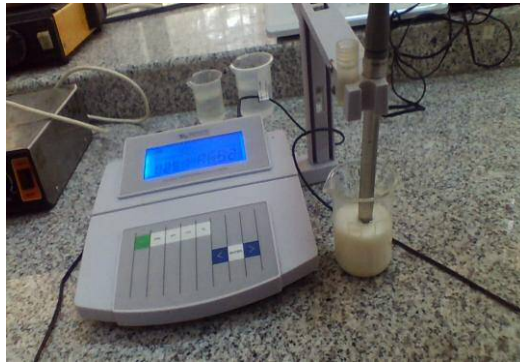
Fig. 2- Mesure de pH du lait
