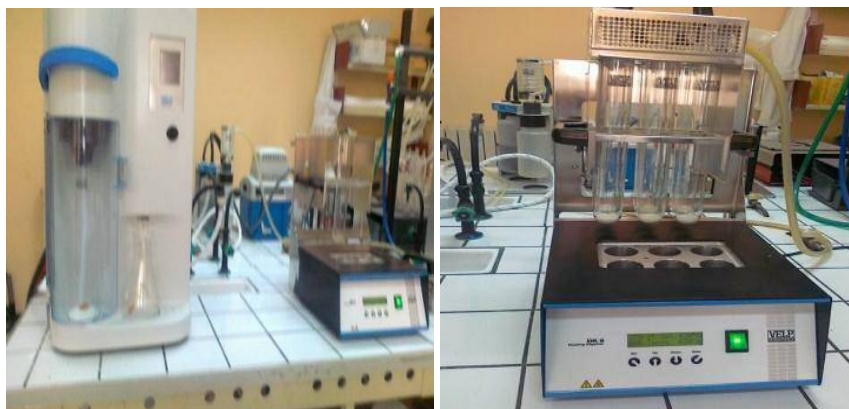
Fig. 10- Détermination des protéines du lait par méthode de Kjeldhal.
