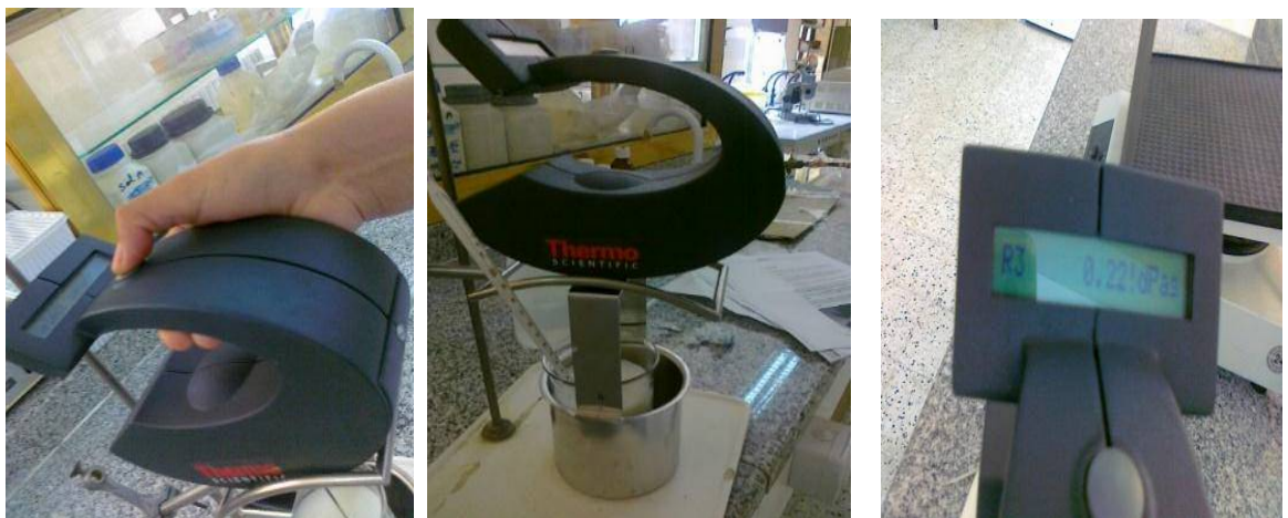
Fig. 5 - Mesure de la viscosité du lait.
