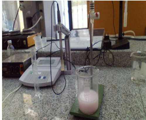
Fig. 3- Détermination de l'acidité titrable du lait.
