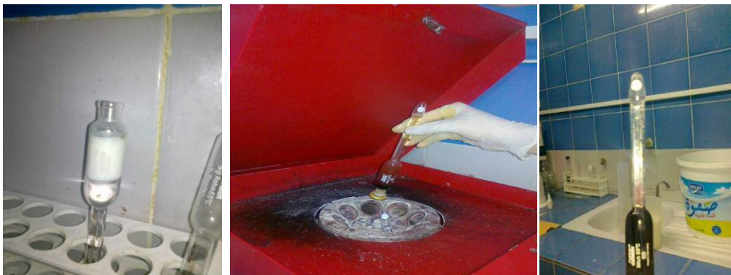
Fig. 9- Détermination de la matière grasse par la méthode de Gerber.
