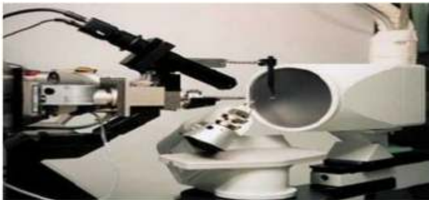
Figure 5 : Diffractomètre à rayons X de géométrie Kappa CCD.
