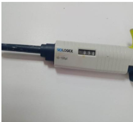
Etape 5 : A l'aide d'une pipette on prendre 0.5 µl d'huiles essentielle de citron
