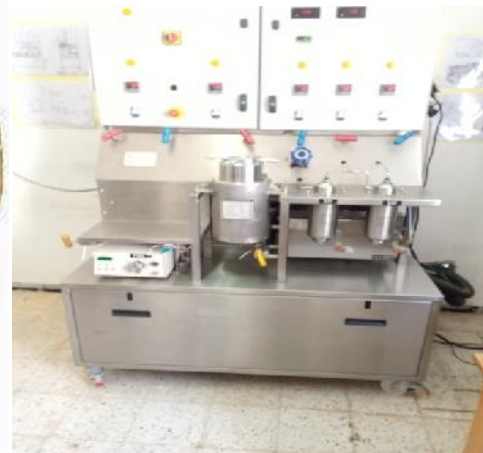
Figure16 : Pilote d'extraction par CO2 Supercritique
