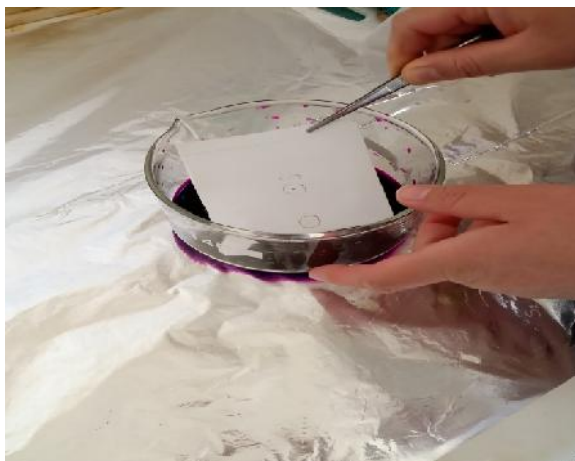
Etape 4: On immergée la plaque dans la solution de \text{KMnO}_4 .
