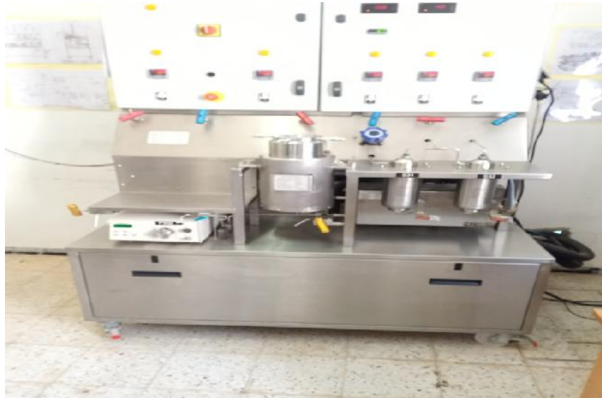
Figure 36 : Pilote d'extraction par CO 2 supercritique.
