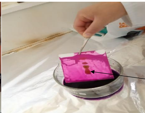
Etape 4: On immergée la plaque dans la solution de \text{KMnO}_4 .
