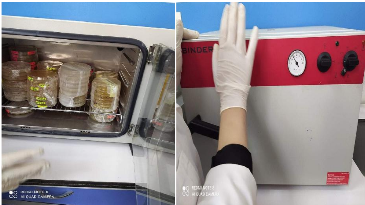
Etape 7 : placée les boîte de pétrie dans l'étuve sous une température de 37 C 0
