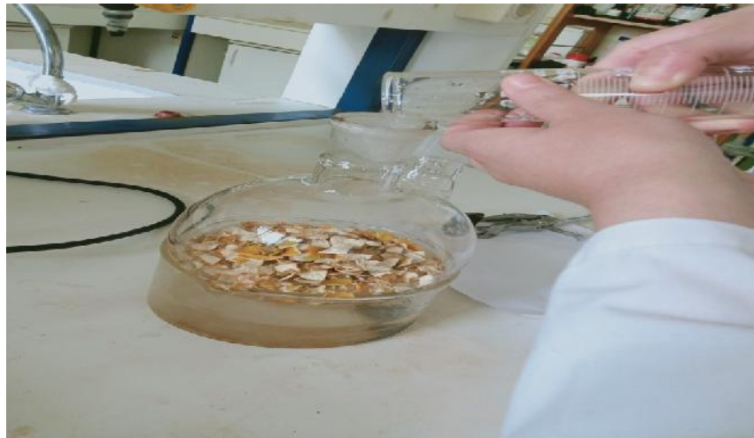
Etape 6 : Déposer tout le zeste dans le ballon avec 700 ml d'eau distillée ainsi que 2 grains de pierre ponce
