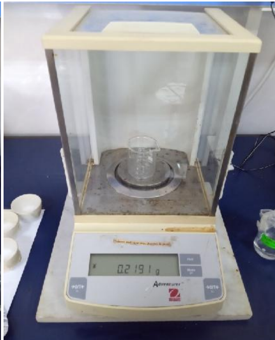
Figure31: La masse de 0.2 ml d'eau distillée
