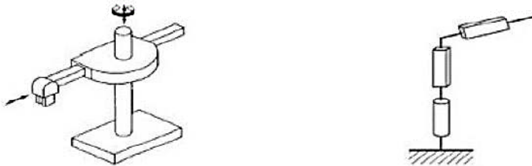
Figure (I.22) : Structure d'un robot cylindrique
