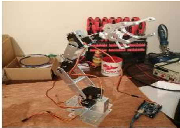
Figure (II.4) : Bras robot entier conçu sur 3D Builder
