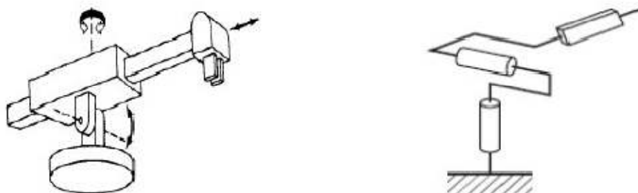
Figure(I.23) : Structure d'un robot sphérique [32].
