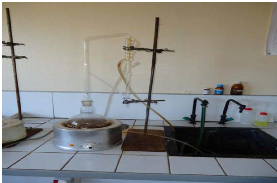
Figure 7: Montage utilisé pour l'extraction des huiles essentielles et leurs dérivés.
