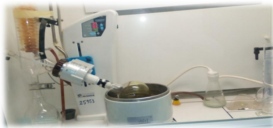
Figure 09: Photo du Rotavapeur utilisé pour sécher l'extrait méthanolique brut.
