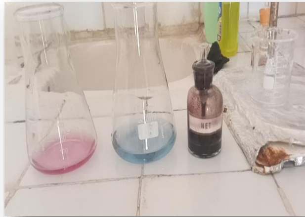
Figure13: dosage de la dureté ou titre hydrotimétrique
