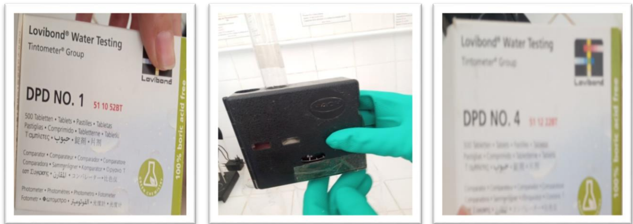
Figure 09: Test de Chlore par des comprimés DPD 1 et DPD 2
