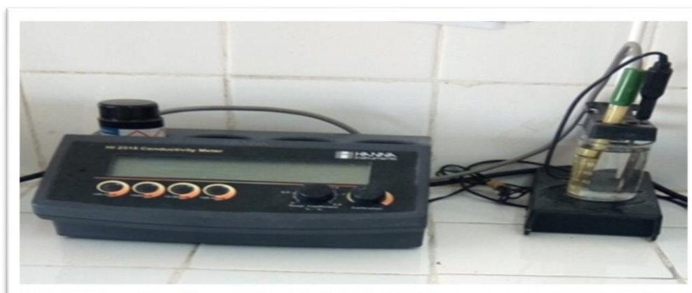
Figure 11 : appareil de La conductivité électrique type HI 2315 (utilisé)
