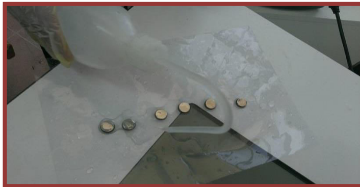
Fig(III.3):Rinçage des échantillons par l'eau distillée.
