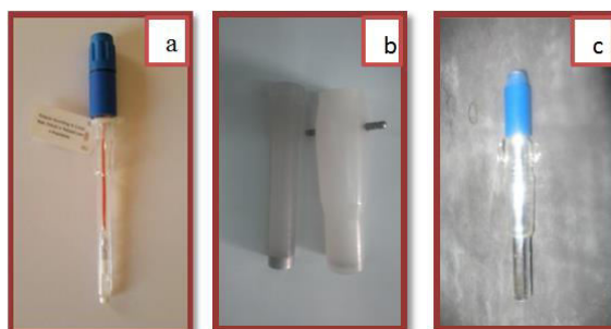
Fig(III.8): (a) : électrode de référence au calomel saturé(ER),( b) : électrode de travail(ET) et (c): contre électrode (CE).
