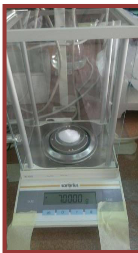
Fig(III.10): Préparation de l'électrolyte (3.5% NaCl).
