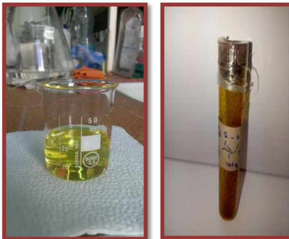
Fig(III.9): Dissolution de l'inhibiteur par le DMF.
