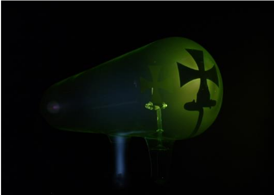
Figure. II.2 : Mise en évidence des rayons cathodiques.
