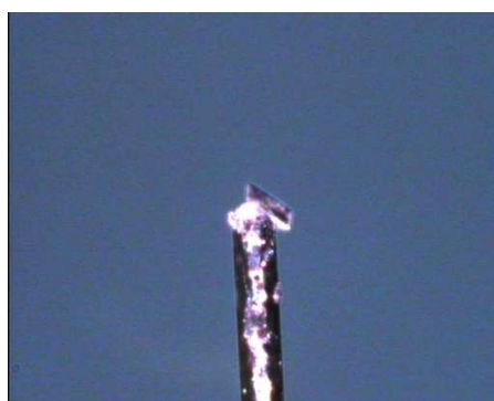
Figure 79 . Cristal du composé (p-AAB) + , (HSeO 3 ) - collé sur le porte échantillon du diffractomètre.
