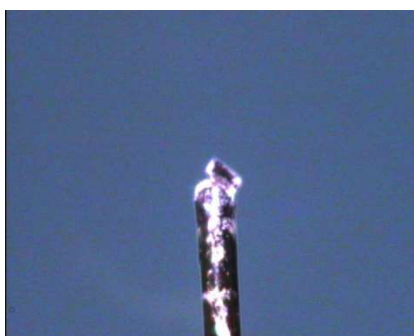
Figure 71 . Cristal du complexe (m\text{-AAB})^+ , (\text{HSeO}_3)^- collé sur le porte échantillon du diffractomètre.
