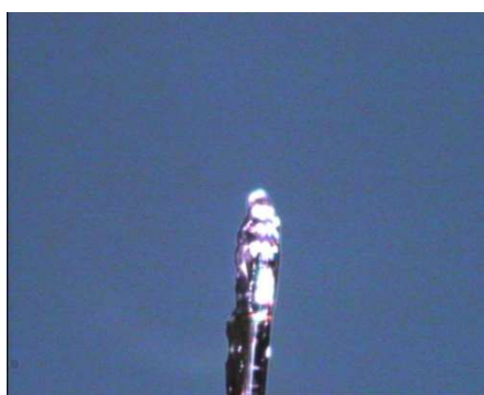
Figure 86 . Cristal du complexe (p-AAB) + , (HSeO 3 ) - , H 2 O sur le porte échantillon du diffractomètre.
