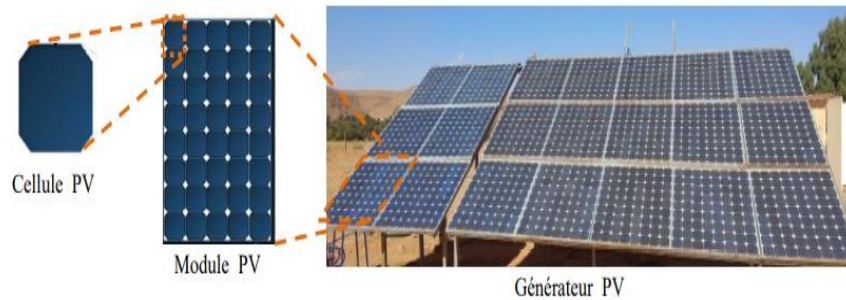
Figure I.2 : Construction de base d'un générateur PV
