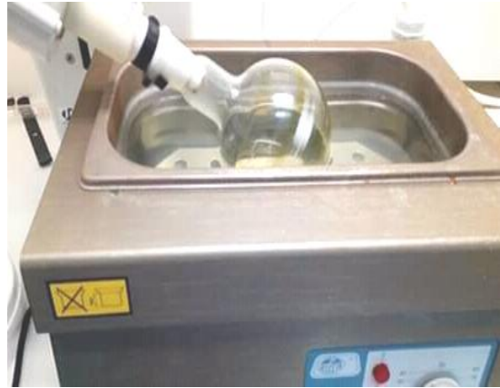
Figure n°24 : évaporation de filtra à 35C°
