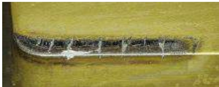
La figure III.9 Usure par fissuration en peigne [1].
