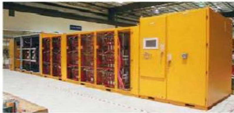
Figure I. 15 Onduleur multi niveaux en pont en H image réelle. [15]
