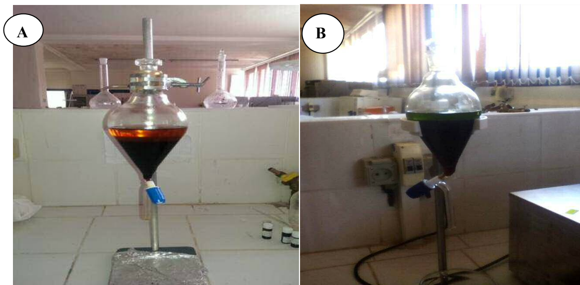
Figure 2. Extraction liquide-liquide de la phase chloroformique (A) et butanolique (B)
