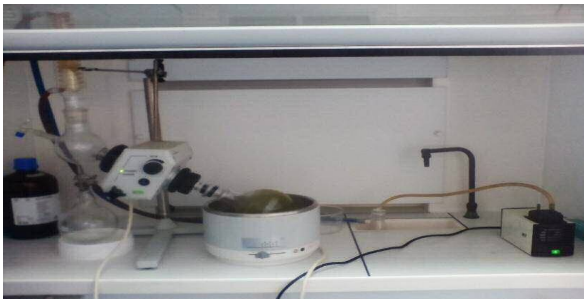
Figure 1. Evaporation des phases organiques obtenues par Rotavapeur
