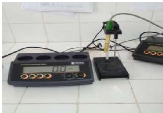
Photographie 01 : Le multi-paramètre utilisé pour la mesure du pH et de la CE.
