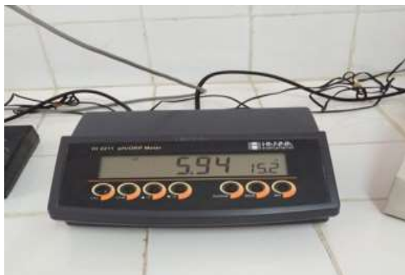
Photographie 01 : Le multi-paramètre utilisé pour la mesure du pH et de la CE.
