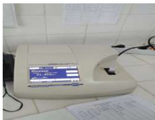
Photographie 04 : dosage des sulfates par spectrophotomètre.
