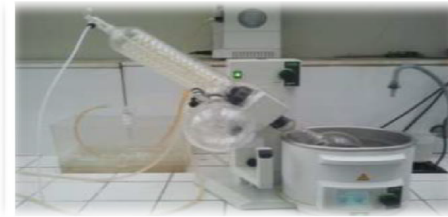
Fig44 : Evaporateur rotatif. (Belidi .,Belaouedj.,2017)
