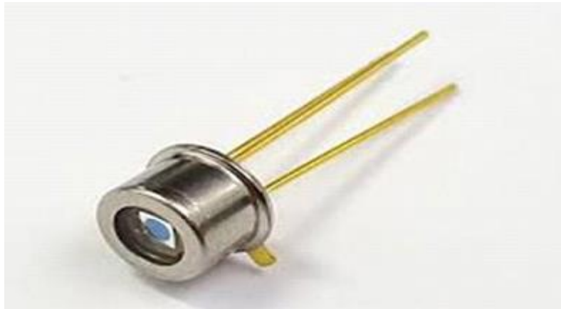
Fig.I.5: photodiode à base de CdS
