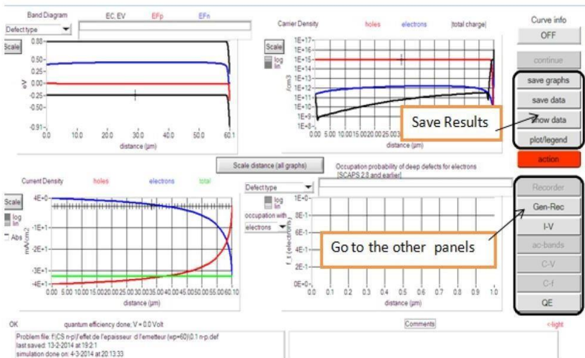
Fig. III. 4: Panneau des bandes d'énergie
