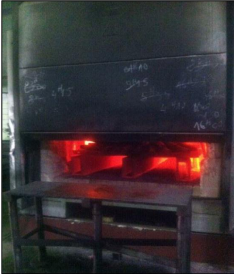
Figure IV.5. Four électrique de trempe
