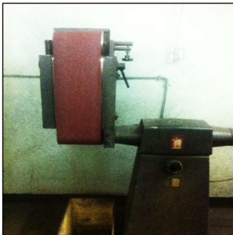
Figure IV.18. Polisseuse à papiers abrasifs Figure IV.19. Polisseuse à pâte diamantée
