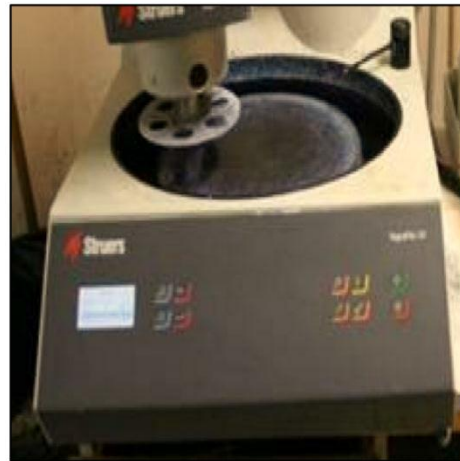
Figure IV.18. Polisseuse à papiers abrasifs Figure IV.19. Polisseuse à pâte diamantée
