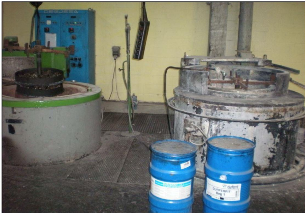
Figure I.1. Installation de nitruration en bain de sel
