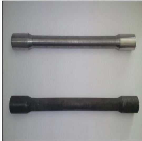
Figure IV.28. Eprouvettes de traction de 42CrMo4 avant et après nitruration
