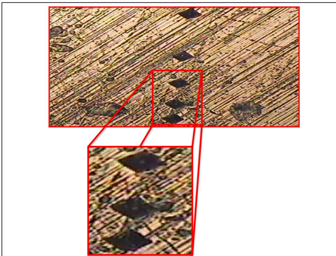
Figure V.19. les empreintes d'indentation de la surface vers le cœur de l'acier 42CrMo4 après la nitruration
