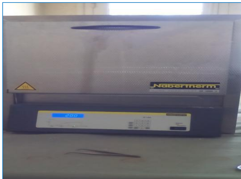
Figure .III.11: Four de marque Nabertherm utilisé pour les traitements thermiques de nos poudres.
