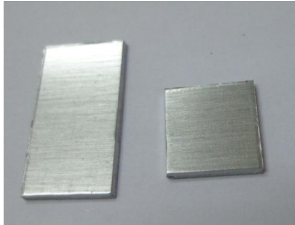
Figure II-3: Echantillons découpés aux dimensions de 1x1cm 2 et 1x2cm 2 . [40]
