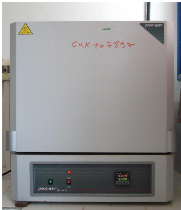
Figure II-4 : Four à moufle prothèrm. [40]
