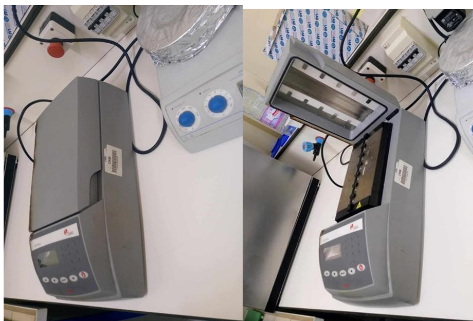
Figure 45 : L'hybridizer utilisé pur l'hybridation des sondes FISH
