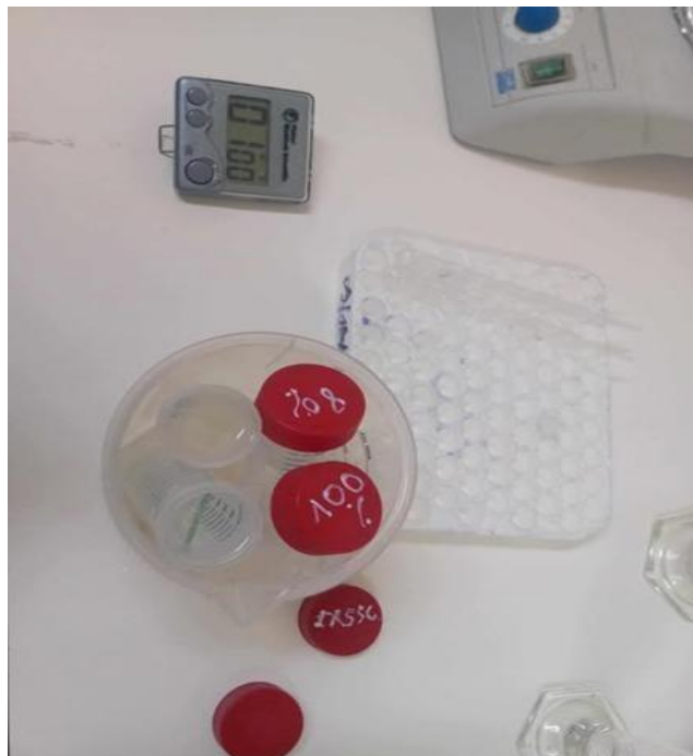
Figure 41 : Prétraitement par le 2XSSC et une série de bains d'alcool 70%, 90% et 100%
