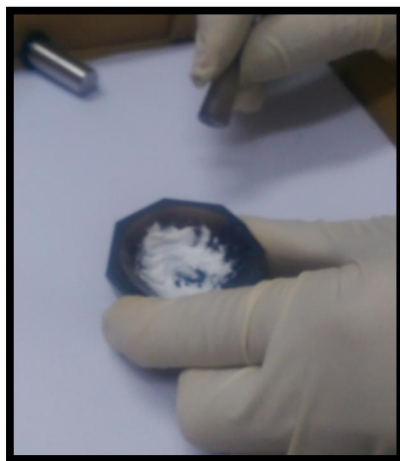
Figure 18 : broyage d'une poudre d'un échantillon dans un mortier en agathe
