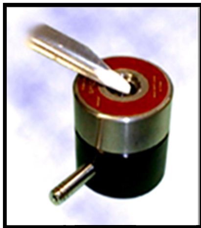
Figure 19 : ajout de la poudre dans la pastilleuse
