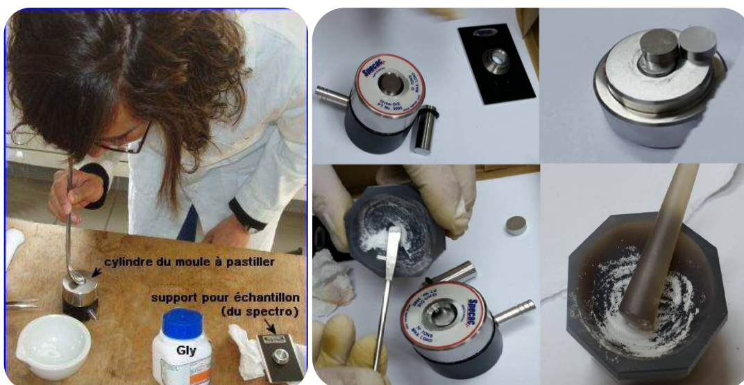
Photographie 04 : Préparation de l'échantillon en pastille de KBr.
