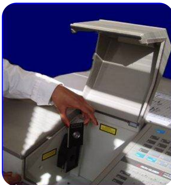
Photographie 03 : Spectrophotomètre IR à transformée de Fourier (FTIR ou IRTF).
