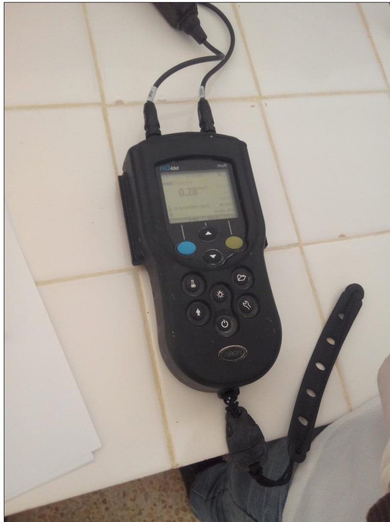
Fig.13 : Le multi-paramètre HACH Q40D (mesure de pH).
