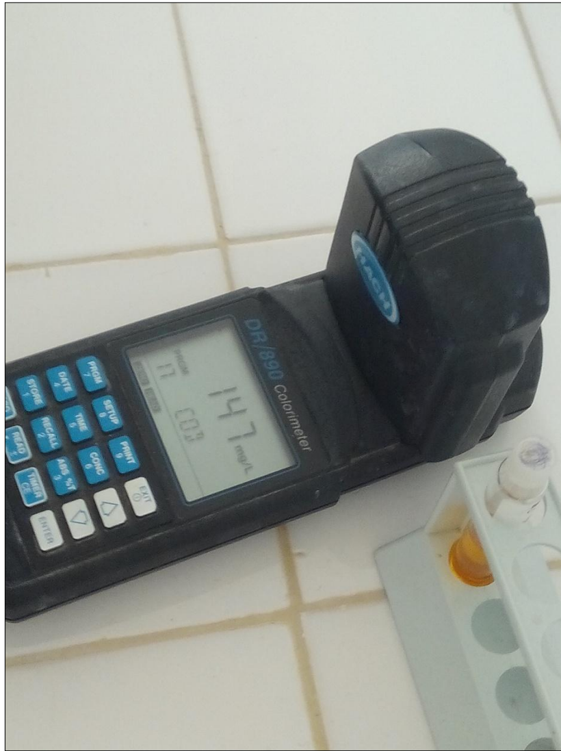
Fig.15 : Le colorimètre HACH DR890.
