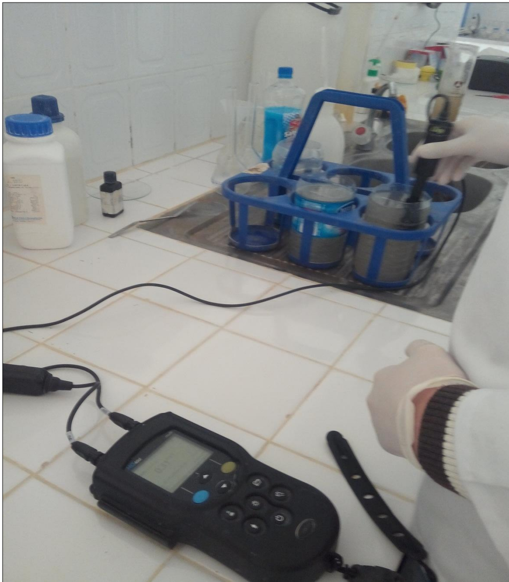
Fig.14 : Mesure de l'oxygène dissout (OD) au niveau de laboratoire de l'ONA Khenchela.
