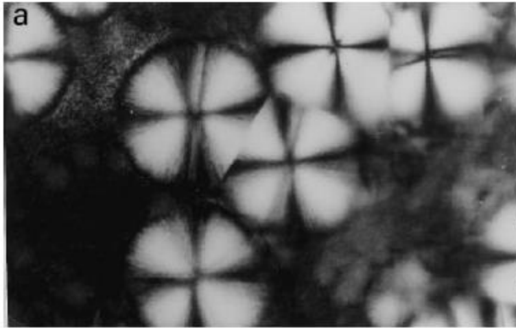
Figure II.12 : Observation micrographique d'un film de PA 6,6. Mise en évidence de sphérolites [42].
