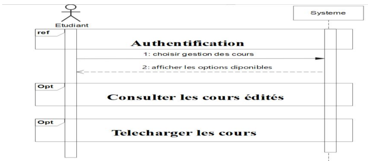
Figure 12 Diagramme de séquence système de « Consulter ou télécharger les cours »
