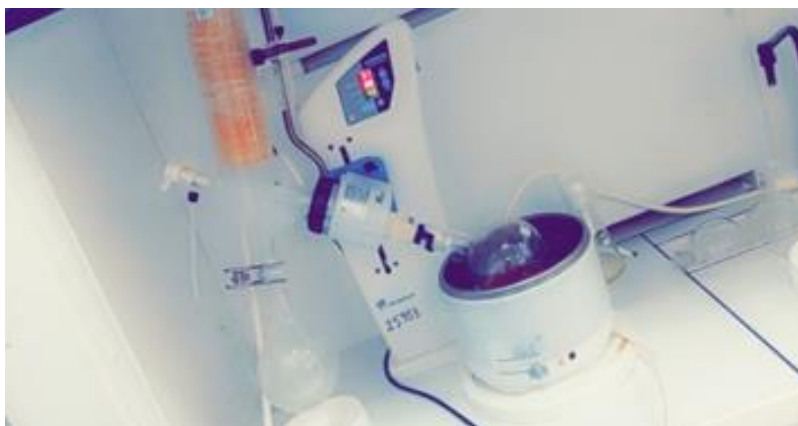
Figure II.13 : Évaporation du solvant
