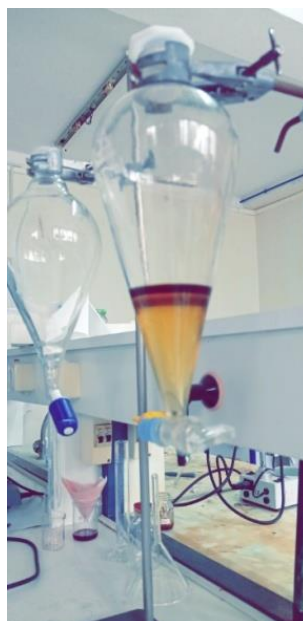
Figure II.12 : Décantation de la caféine.
