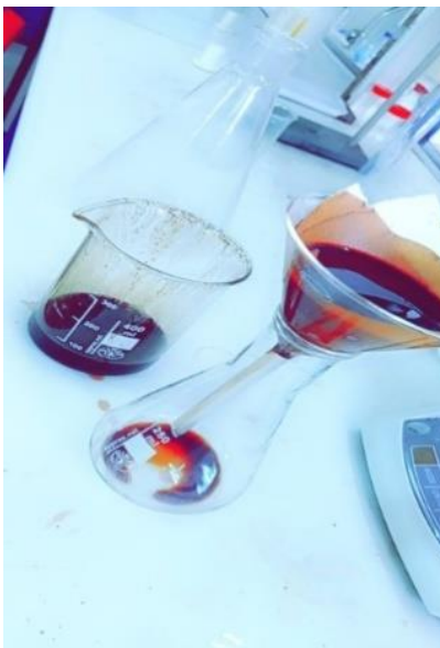
Figure II.4 : Filtration de la caféine
